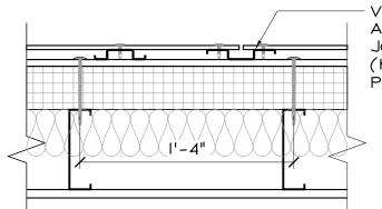
VERTICAL ATTACHMENT RAIL AT ALL VERTICAL CLADDING JOINTS. PREFINISH BLACK. (KNIGHT WALL, PANEL RAIL OR REVEAL-RAIL)
