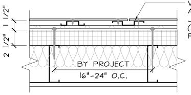
VERTICAL ATTACHMENT RAIL AT ALL VERTICAL CLADDING JOINTS. PREFINISH BLACK. (KNIGHT WALL, PANEL RAIL OR REVEAL-RAIL)
