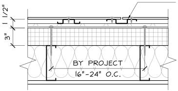
VERTICAL ATTACHMENT RAIL AT ALL VERTICAL CLADDING JOINTS. PREFINISH BLACK. (KNIGHT WALL, PANEL RAIL OR REVEAL-RAIL)
