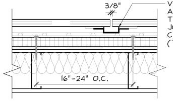
VERTICAL INSTALLATION RAIL AT ALL VERTICAL TERRA-COTTA JOINTS AND INSTALLATION CLIPS. PREFINISH BLACK. (TERREAL, PITERAK RAIL)
